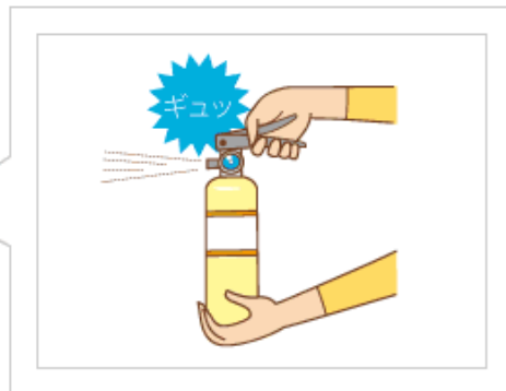
火元からある程度離れ、片方の手で消火器の底を持ち、ノズルを火元に向けます。 ※ホース付の消火器は使用方法が異なります。消火器をみて確認しておきましょう。
