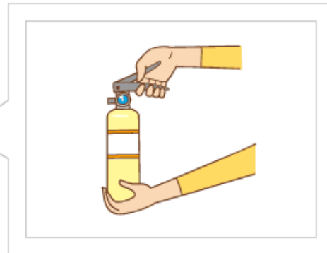
火元からある程度離れ、片方の手で消火器の底を持ち、ノズルを火元に向けます。 ※ホース付の消火器は使用方法が異なります。消火器をみて確認しておきましょう。
